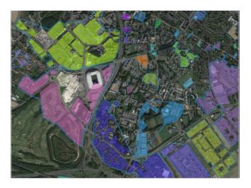
Enfin pour définir les limites des sites, les opérations de dilatation, fusion et érosion par buffer de 20 m ont été appliquées aux géométries clusterisées. La figure ci-dessous présente les enveloppes entourant les UF après l'application de ce traitement.
